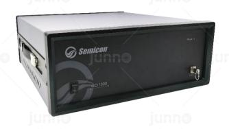
OCI1300是一款超高精度的光纤断点检测、损耗测量 仪器。其原理基于光频域反射技术与光外差检测技术相结 合,实现100m测量范围内的空间分辨率可达10um。本产 品可在待测光纤链路中轻松查找判别宏弯、接头、暗纹、 连接点和断点,精准测量插损、回损。非常适合硅光芯片、 光纤微结构的定量测试和品质监测,以及光纤长度测量, 其中测量精度可达0.1mm,并可扩展分布式温度应变测量。
